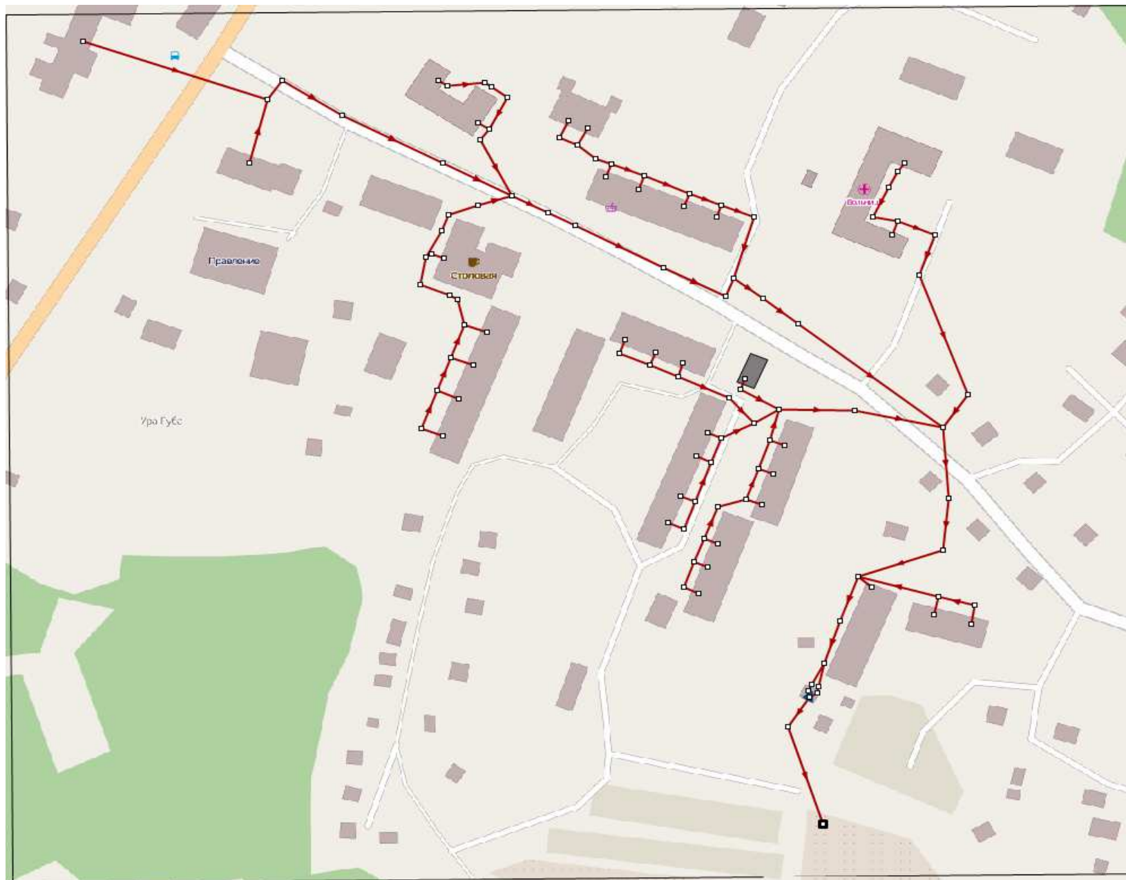
Рисунок 12 Маршруты прохождения трубопроводов по технологической зоне ВО
